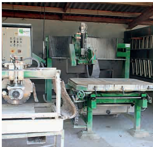
Mit der Maschine rechts lassen sich großformatige dicke Natursteinplatten schneiden
